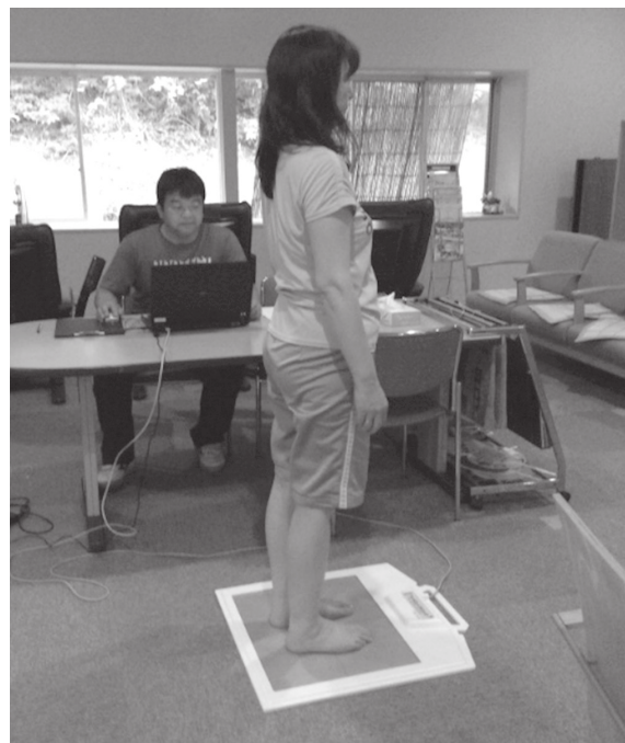
写真5 静止立位時の足圧分布測定
