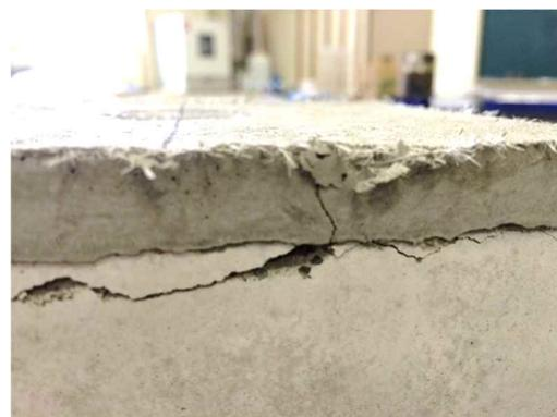
Fig. 4-12 被覆供試体 (F5) に発生したひび割れ
